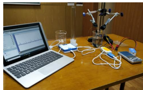
Рис.1. Вимірювання ЕРС найпростішого гальванічного елемента цифровим вимірювальним комплексом Einstein.
